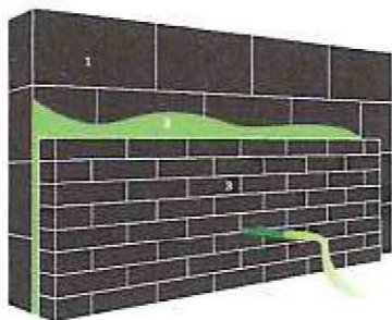
1. Dragende muur | 2. Ingeblazen isolatie | 3. Gevelsteen / gevelbekleding
