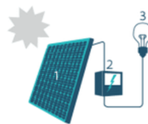
1. Zonnepaneel | 2. Omvormer | 3. Elektrische toestellen
