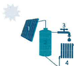
1. Zonnecollector | 2. Opslagvat zonneboiler | 3. Sanitair warm water | 4. Afgrite-element voor ruimteverwarming (optioneel)
