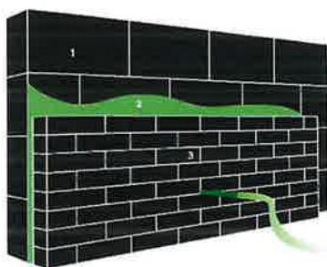
1. Dragende muur | 2. Ingeblazen isolatie | 3. Gevelsteen / gevelbekleding
