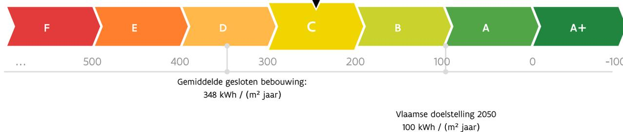
De energiescore en het energielabel van deze woning zijn bepaald via een theoretische berekening op basis van de bestaande toestand van het gebouw. Er wordt geen rekening gehouden met het gedrag en het werkelijke energieverbruik van de (vorige) bewoners. Hoe lager de energiescore, hoe beter.
