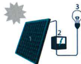
1. Zonnepaneel | 2. Omvormer | 3. Elektrische toestellen
