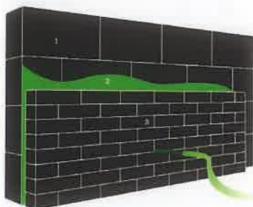
1. Dragende muur | 2. Ingeblazen isolatie | 3. Gevelsteen / gevelbekleding
