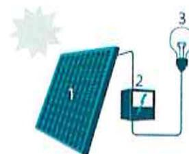
1 Zonnepaneel | 2 Converter | 3 Elektrische installaties
