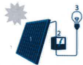
1. Zonnepaneel | 2. Omvormer | 3. Elektrische toestellen
