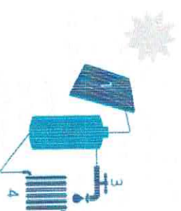
1 Zonnecollector 2 Opslagvat zonnecollector 3 Sanitair warm water 4 Afgeleidend voor ruimteverwarming
