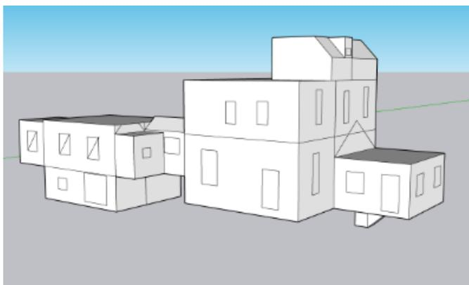
Le volume protégé d'un logement reprend tous les espaces du logement que l'on souhaite protéger des déperditions thermiques que ce soit vers l'extérieur, vers le sol ou encore des espaces non chauffés (cave, annexe, bâtiment mitoyen...). Il comprend au moins tous les locaux chauffés. Lorsqu'une paroi dispose d'un isolant thermique, elle délimite souvent le volume protégé.
