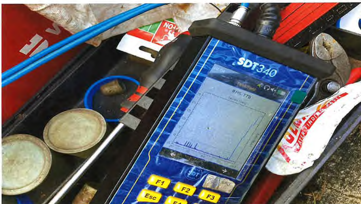
Enregistrement des capteurs avec la fuite calibrée
