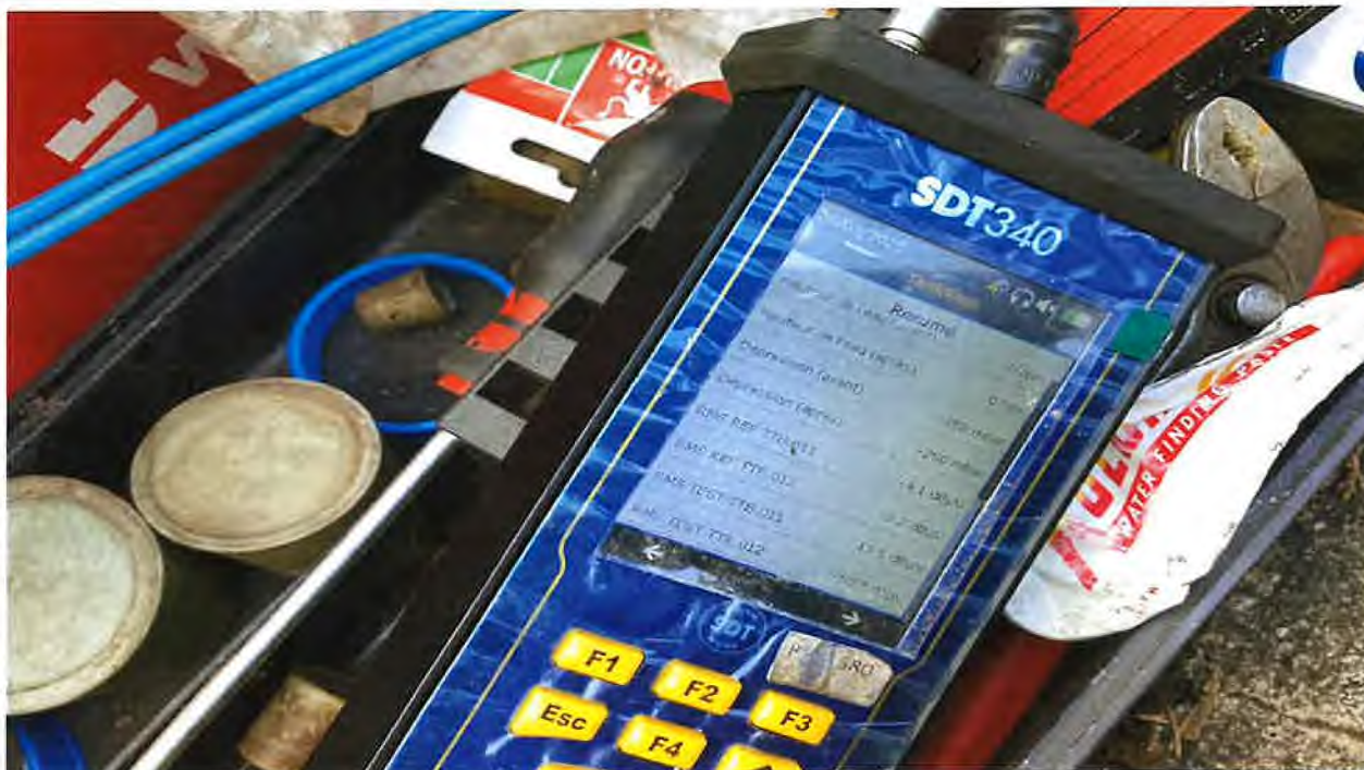
Enregistrement des capteurs avec la fuite calibrée
